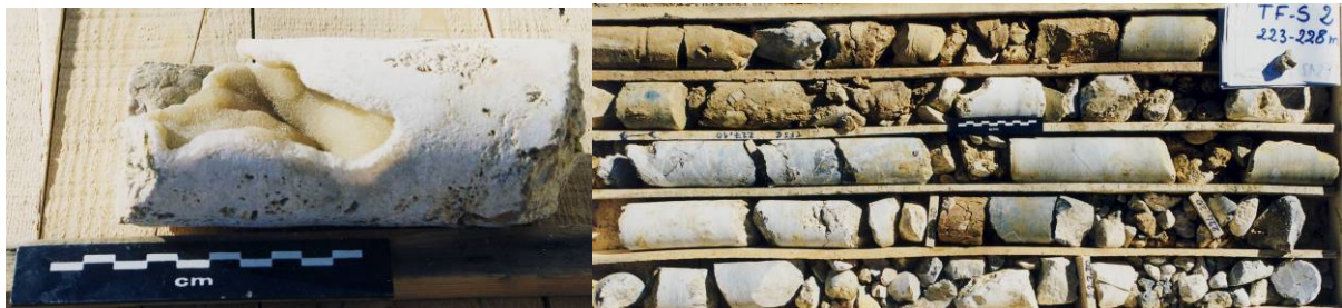
Figure 4. Carottes prélevées dans un aquifère karstique non fonctionnel, sous un gisement de lignite occupant le fond d'un graben miocène de l'est de la Turquie. A gauche, cavité tapissée de calcite déposée en milieu noyé, héritée d'une phase de karstification miocène. À droite, sédiments intrakarstiques typiques et cavités ouvertes.
