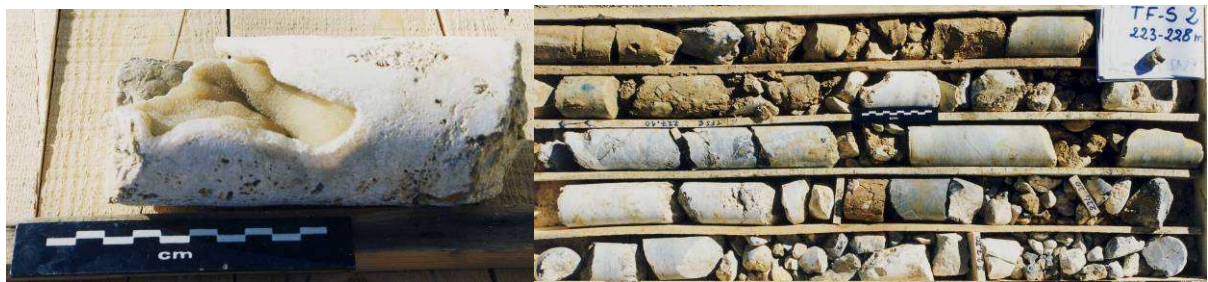
Figure 4. Carottes prélevée dans un aquifère karstique non fonctionnel, sous un gisement de lignite occupant le fond d'un graben miocène de l'est de la Turquie. A gauche, cavité tapissée de calcite déposée en milieu noyé, héritée d'une phase de karstification miocène. À droite, sédiments intrakarstiques typiques et cavités ouvertes.
